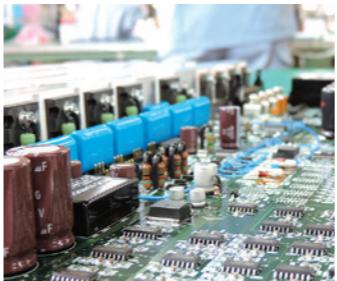
基板実装グループでは、面実装部品(チップLCR、SOP、QFPなど)の取付やディスクリート部品のはんだ付け(フローはんだ付け)の他、極小ロット対応の基板改造(リワーク、パターンカット、ジャンパー配線など)も行います。
